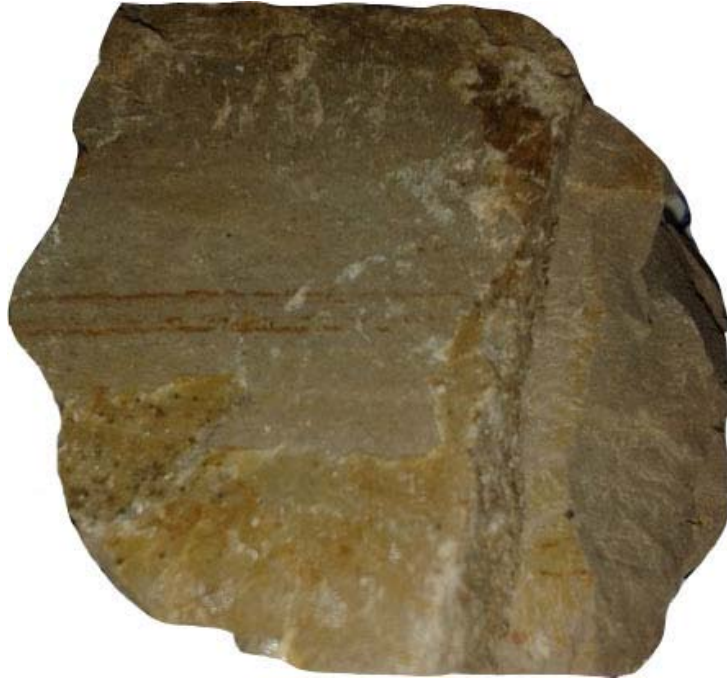
Рисунок 20 – Образец 19. Осветленная ожезненная порода. Шалкиинская свита (x1,8)
