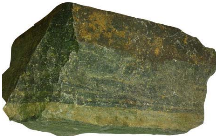
Рисунок 14 – Образец 2а. Углисто-кремнистая порода с прожилками кальцита и мелкими полостями выщелачивания. Шалкиинская свита (x2)
