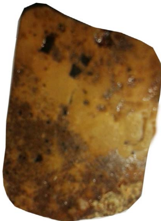
Рисунок 7– Брекчия ожелезненная с включениями рудного минерала. Карамурунская свита. Аншлиф, образец № 22, натуральная величина
